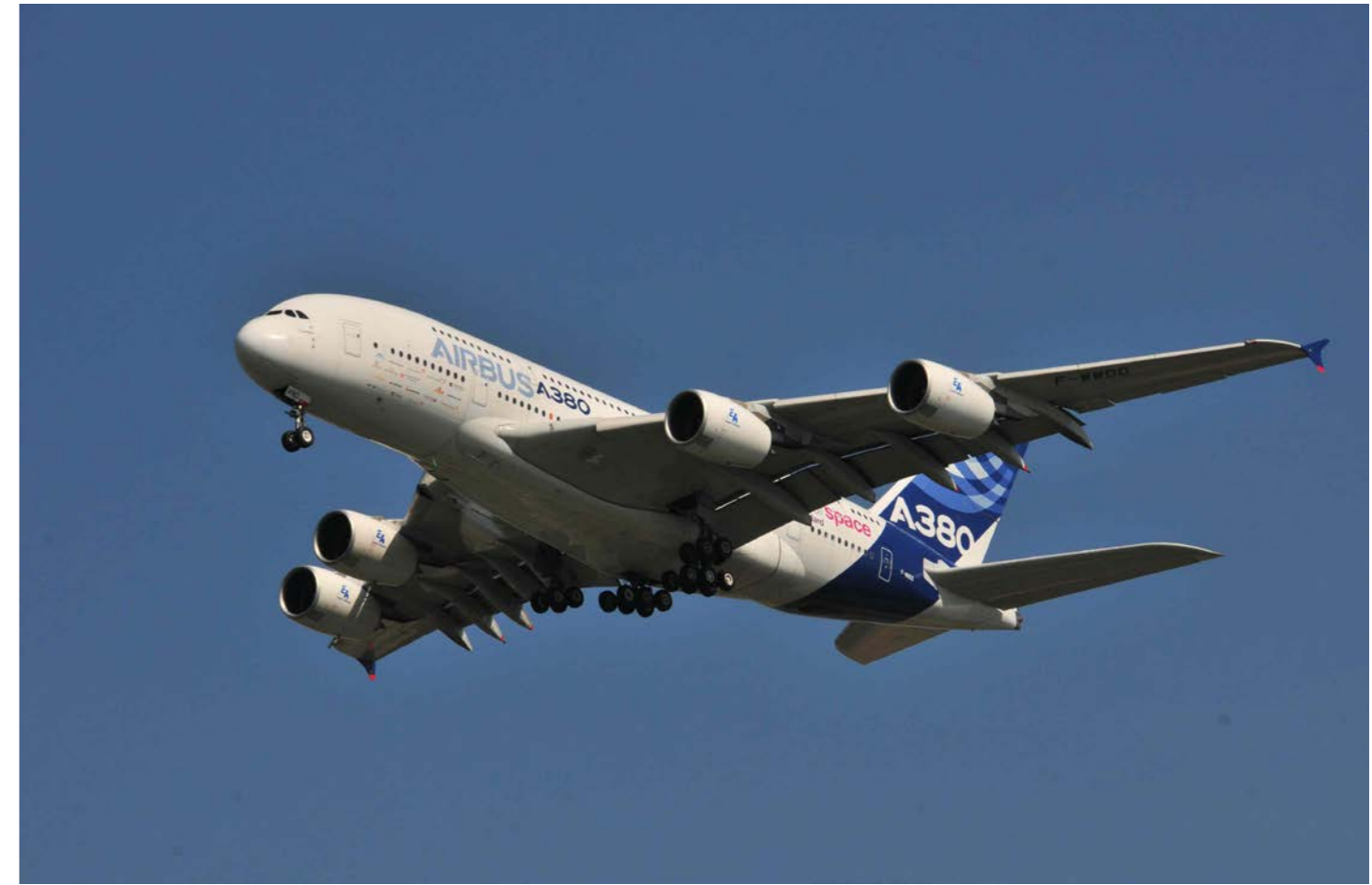
Fig. 3 : Un Airbus A380 : assemblé sur différents sites de production répartis dans plusieurs pays, il est constitué de plus de 3 millions de pièces détachées, comporte plus de 530 km de câbles, plus de 100'000 liaisons électriques... Faut-il pour autant le qualifier de « système complexe » ? Photo © Ph. Hertig, Payerne, septembre 2014.
